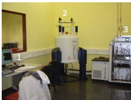
FIG. 1.3 – Une vue d'ensemble de l'appareillage : la station informatique ①, l'aimant supra-conducteur ② et la console ③
