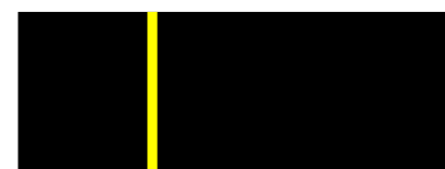
▲ Spectre d'absorption de raies. Les raies du spectre d'absorption ont les mêmes longueurs d'ondes que les raies du spectre d'émission.
