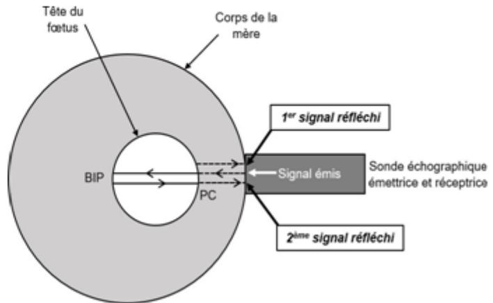
On mesure l'écart de temps  $\Delta t$  entre les réceptions des deux signaux réfléchis.
