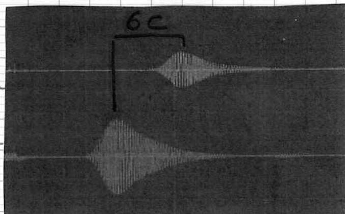
Sur mon écran, je compte un décalage de 6 carreaux entre les deux signaux perçus. Hors on m'indique qu'un carreau représente  $200\text{ }\mu\text{s}$ . Je peux calculer le décalage de temps  $\Delta t = 6 \times 200 = 1200\text{ }\mu\text{s}$  entre les deux signaux perçus.
