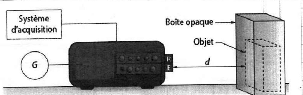
Et l'aide de l'émetteur à onde ultrasonores, j'essaie de déterminer l'objet caché dans la boîte opaque
