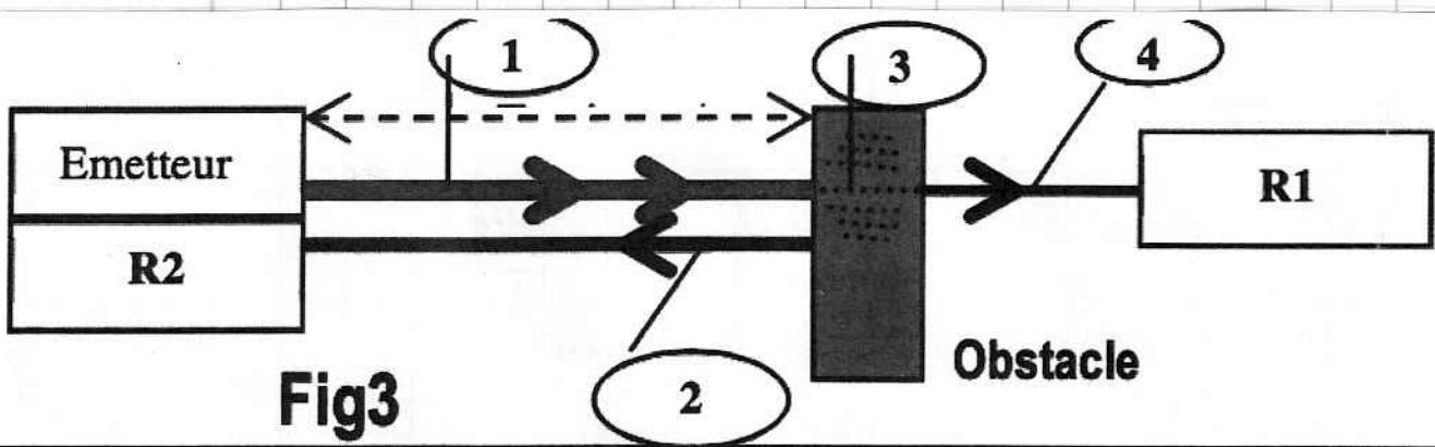
L'émetteur envoie une onde n°1 vers un obstacle n°3. Un récepteur R1 perçoit le signal n°4 transmis à travers l'obstacle, alors que le récepteur R2 perçoit le signal réfracté n°2 par l'obstacle.
