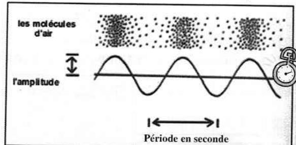
Cela signifie qu'entre chaque trame d'air comprimé lors du déplacement d'une onde ultrasonore, il y a une distance d'environ 8 mm.
