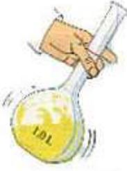
**5** on ajuste le volume au trait de jauge en ajoutant du solvant à l'aide d'une pissette d'eau distillée ou d'une pipette
