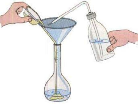
**3** dans la fiole jaugée de  $1,0\text{ L}$ , on introduit environ  $0,5\text{ L}$  de solvant.
