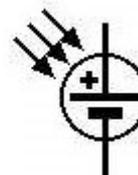
Une cellule photovoltaïque, est un composant électronique qui, exposé à la lumière (photons), produit de l'électricité grâce à l'effet photovoltaïque.
